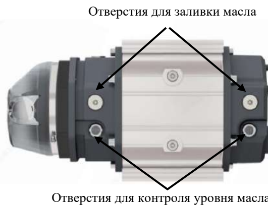
Рисунок 24. Заливка и контроль уровня масла при установке счетчика G16-G400 на вертикальном участке трубопровода
