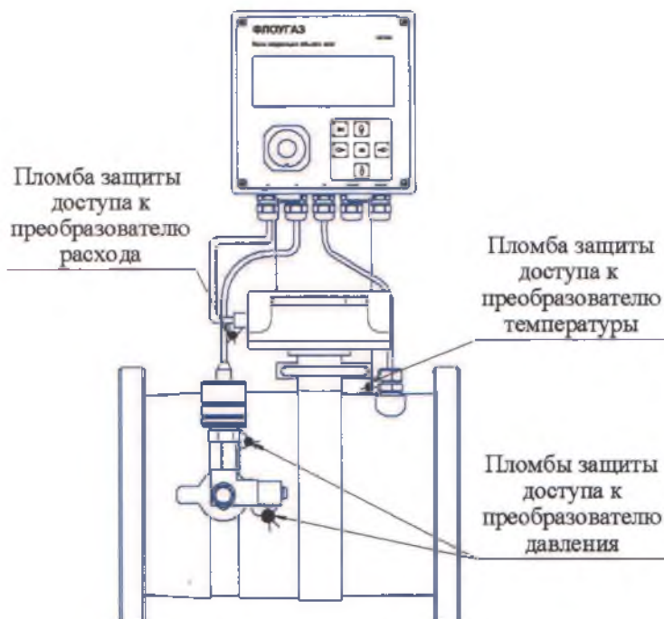
Рисунок 2 - Схема опломбировки комплекса
