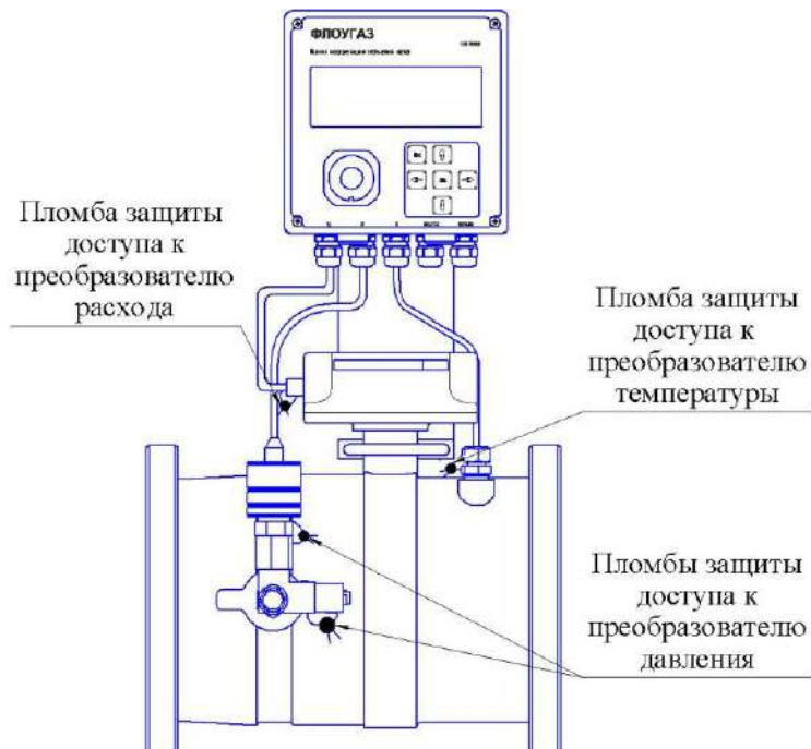
Рисунок 2 – Схема пломбировки комплекса
