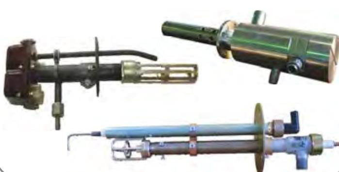
Назначение – контроль и обеспечение безопасности процессов розжига и горения в топке котла. Основным устройством является фотодатчик. Различают сигнализаторы горения (приборы, получающие информацию от фотодатчика и вырабатывающие дискретный управляющий сигнал) и сигнализирующие фотодатчики (приборы совмещающие в себе две функции одновременно).
