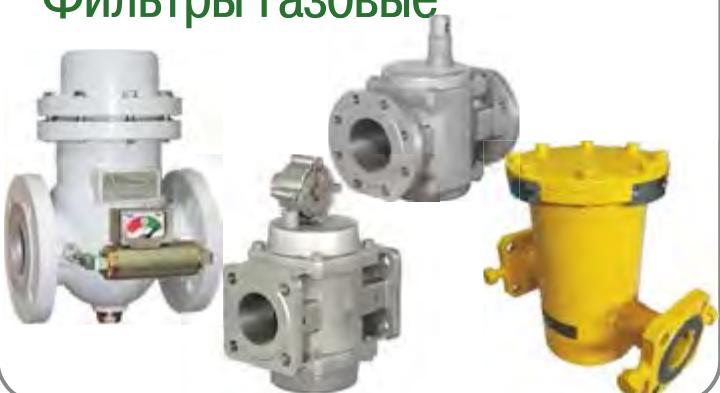
Предназначены для установки на газопроводы перед измерительным газовым оборудованием (счетчиками газа) и запорно-регулирующей арматурой с целью очистки одно- и многокомпонентных газов (воздух, природный газ и др.) от смолистых веществ, пыли, песка, металлической окалины и других твердых частиц с целью повышения надежности и долговечности работы установленного за ними оборудования.
