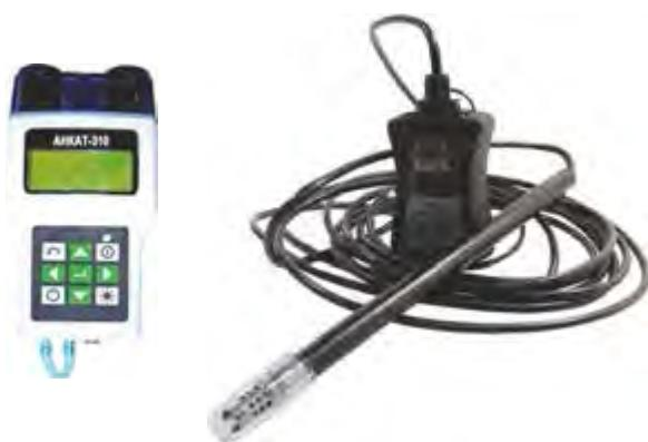
Предназначены для проведения периодического измерения параметров различных газов при проведении регулировочных работ по оптимизации рабочих режимов в процессах предприятий различных отраслей промышленности, прежде всего горения различных видов топлива в котельных разной мощности (котлов, турбин, горелок).
