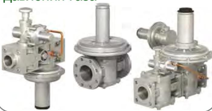
Регуляторы нулевого давления предназначены для пропорционального регулирования расхода газа в зависимости от разрежения на выходе либо в контрольной точке трубопровода и поддержания газо-воздушной смеси в постоянном соотношении.
